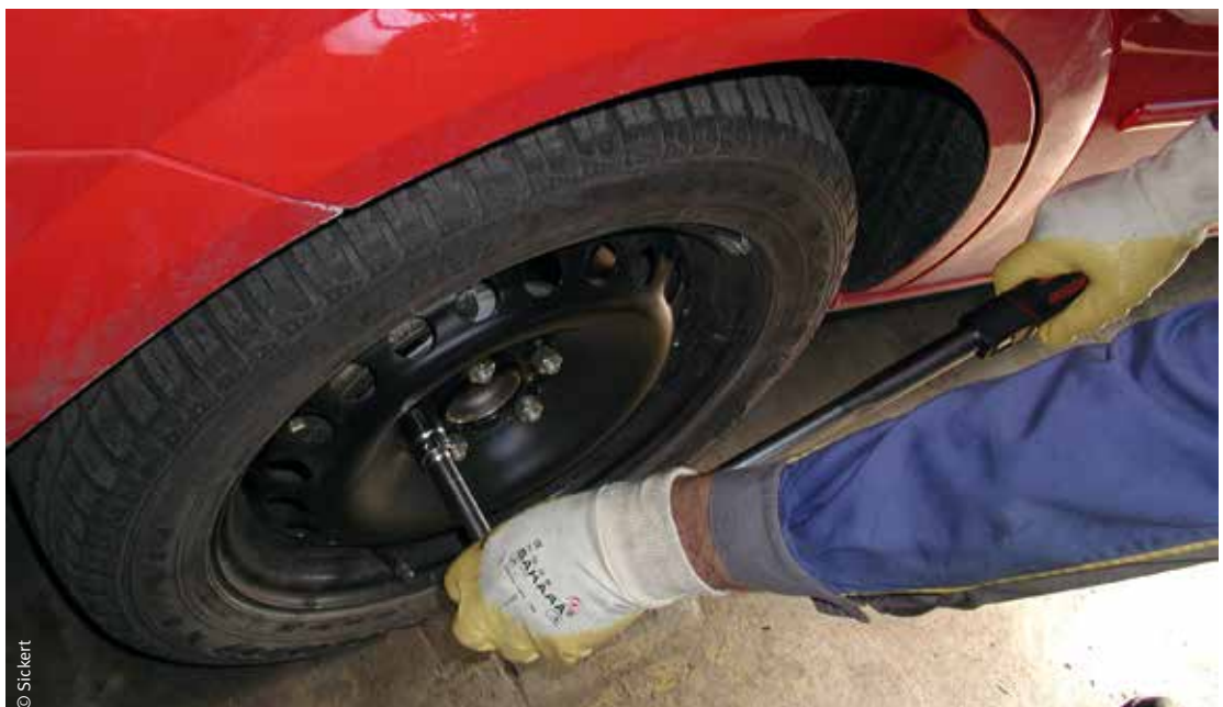
Abb. 2: Schützen bedingt vor Öl und Schmutz – Nitrilkautschuk-Handschuhe bei Kfz-Arbeiten
